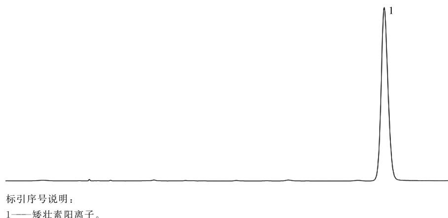
图 1 矮壮素可溶液剂的离子色谱图
